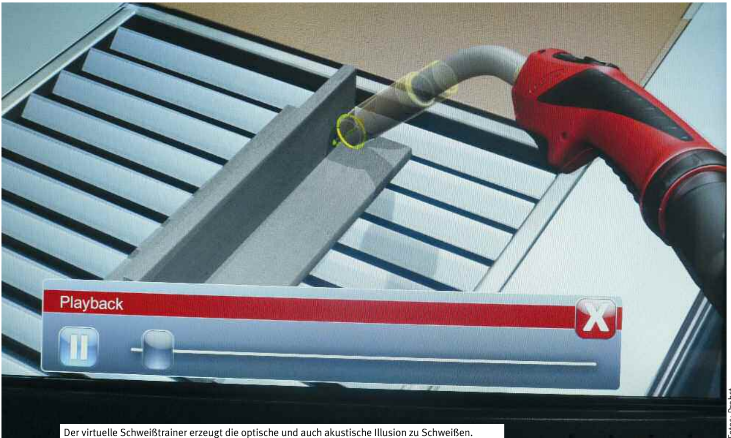
Der virtuelle Schweißtrainer erzeugt die optische und auch akustische Illusion zu Schweißen.
